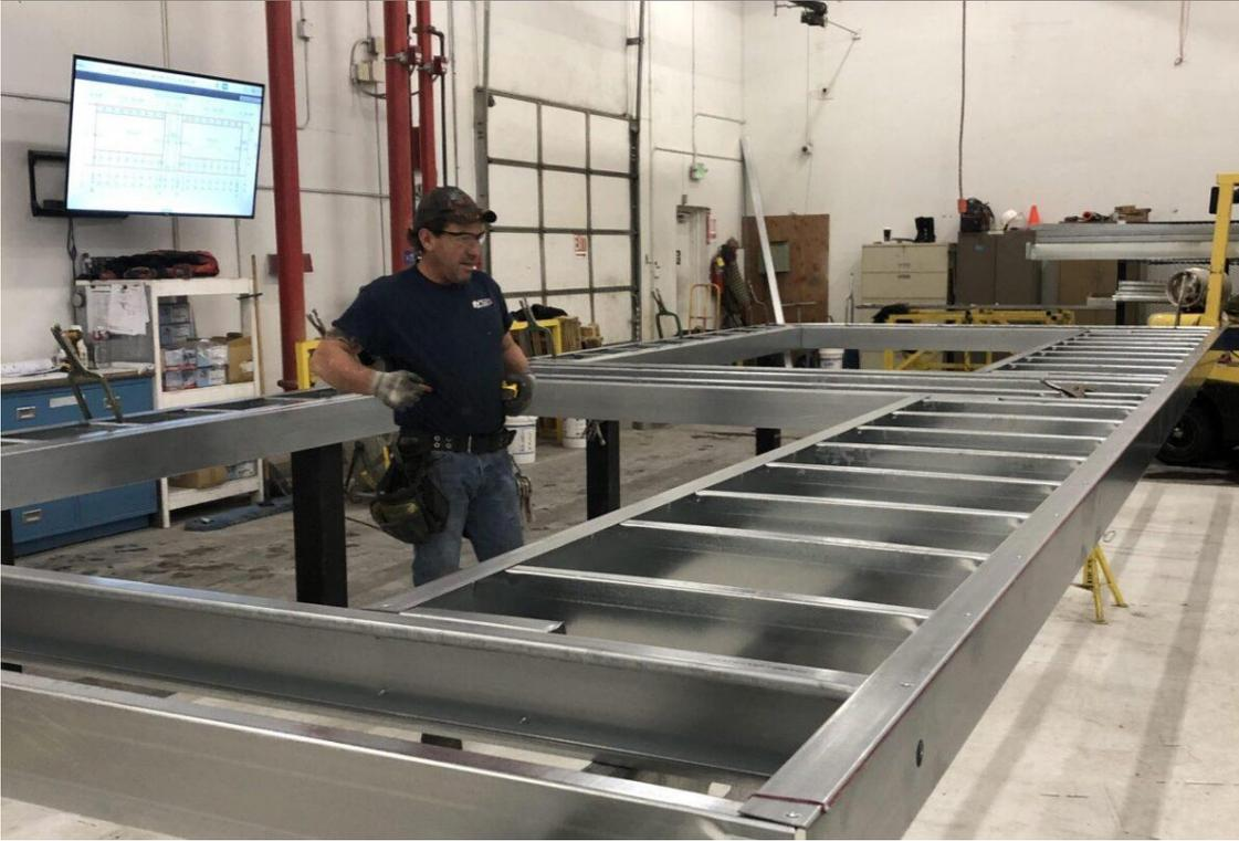
Gegenwertig werden Untergerüste automatisiert hergestellt, die Wärmedämmung und PV Panele in der Fertigung manuell installiert und danach fertig auf die Baustelle transportiert.
